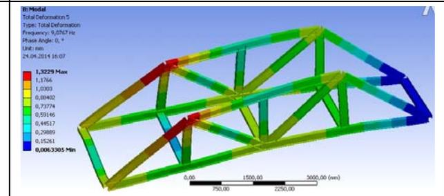
*Profil I2, secțiune 950mm<sup>2</sup>*
