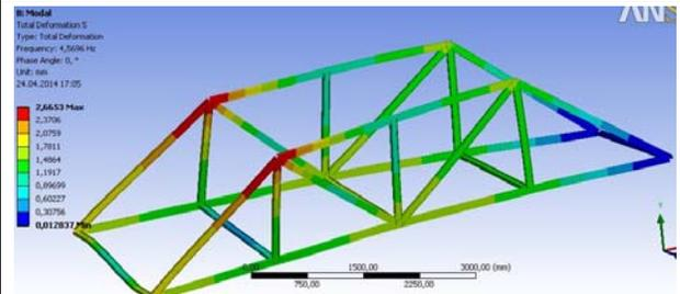
*Profil I3, secțiune 237,5 mm<sup>2</sup>*
